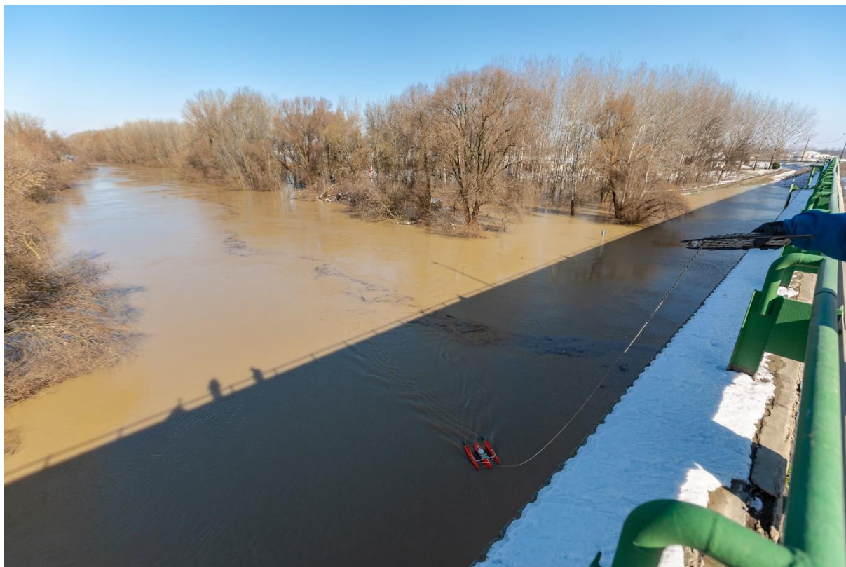
Vízhozammérés a Kettős-Körösön
